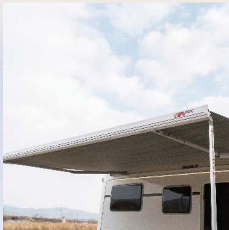
4M FIAMMA AWNING 피암마 차양막 어닝 지지대 빌트인 수납. 각도 조절 피치PITCH 시스템
