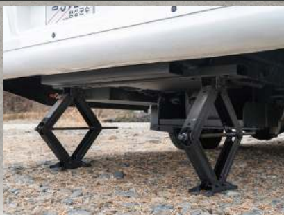
REAR TWIN OUTRIGGER 아웃트리거 고내하중 다이아몬드형 아웃트리거로 생활안정성을 높여줍니다.
