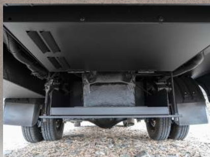
BATTERY 인산철 배터리 하부에 600A 인산철 배터리 배치 (최대 1200A) 주행안정성 및 내부 공간 확보
