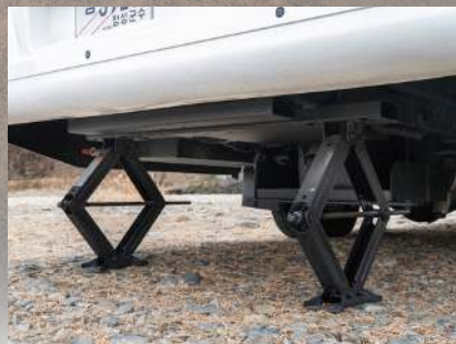
REAR TWIN OUTRIGGER 아웃트리거 고내하중 다이아몬드형 아웃트리거로 생활안정성을 높여줍니다.
