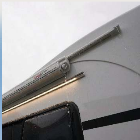
LED AWNING LIGHT / WATER-GUARD RAIL 어닝 LED 조명 / 빗물받이 (옵션) 자체 개발 일체형 빗물받이 적용. LED 조명을 안전하게 지지합니다.
